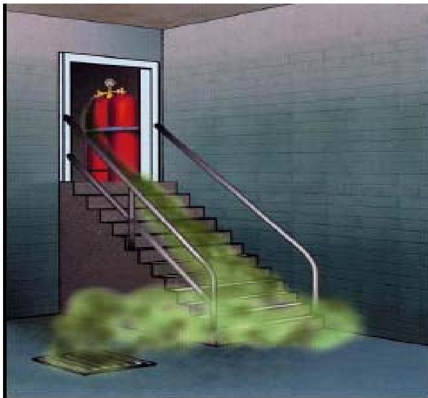
Εικ. 2.3: Τρόπος εξάπλωσης υγρατοποιημένων αερίων.
