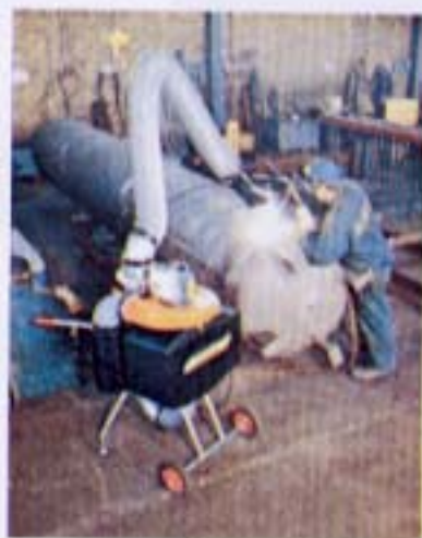
Κινητή συσκευή-φίλτρο με εύκαμπτο βραχίονα τοπικού εξαερισμού
