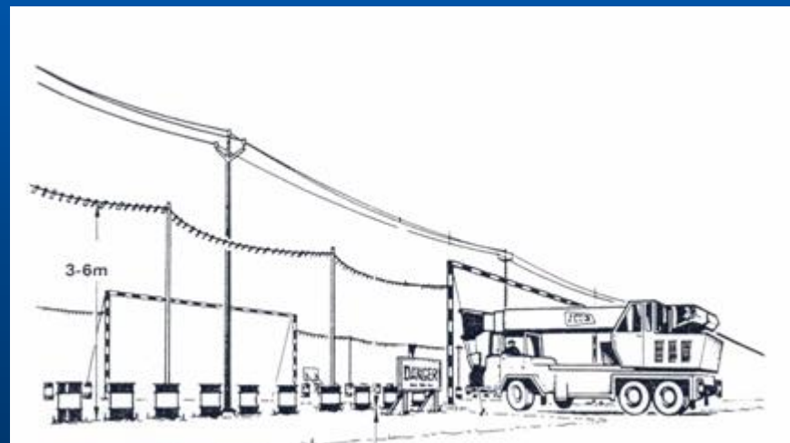
Ξύλινα πλαίσια για τον περιορισμό του ύψους και την ασφαλή διέλευση των μηχανημάτων έργου
