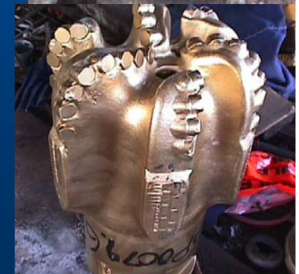
Πολυκρυσταλλικά συμπαγή αδαμαντοτρύπανα ( Polycrystalline Diamond Compact bits-PDC bits )
