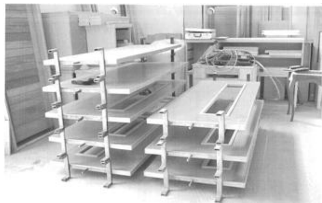
Φωτογραφία της εγκατάστασης του συστήματος στην εργασία βαφής των επίπλων.
