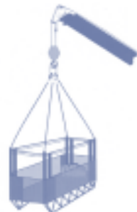
Εικ. 5: Ανάρτηση από 4 συρματόσχοινα με συντελεστή ασφάλειας 5:1
