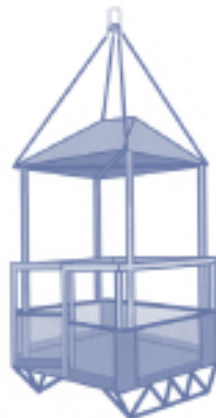
Εικ. 3: Καλάρι με οροφή και ανάρτηση από τέσσερα σημεία με δακτύλιο
