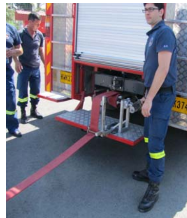
Τύλιγμα υδροσωλήνα Τυλικτήρα με Φορητό Μηχανισμό
