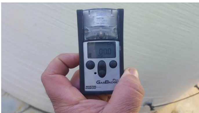
Χρήση φορητού μετρητή αερίων πριν την εκτέλεση εργασιών στα υπόγεια των αντλιοστασίων.
