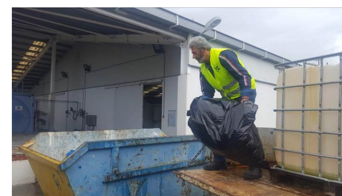
Τα σχαρίσματα τοποθετούνται σε σκίπ με το χέρι.
