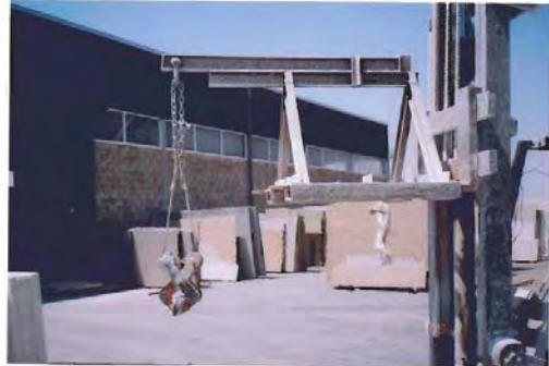
Φωτογραφία 3. Ειδικός μηχανισμός παραλαβής πλακών
