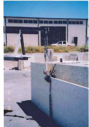
Φωτογραφία 3. Ειδικός μηχανισμός παραλαβής πλακών
