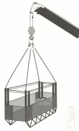
Εικ. 5: Ανάρτηση από 4 συρματόσχοινα με συντελεστή ασφάλειας 5:1
