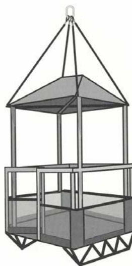
Εικ. 3: Καλάθι με οροφή και ανάρτηση από τέσσερα σημεία με δακτύλιο
