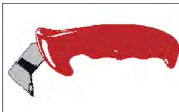
Χαράκτης εφοδιασμένος με σκληρό κοπήρα
