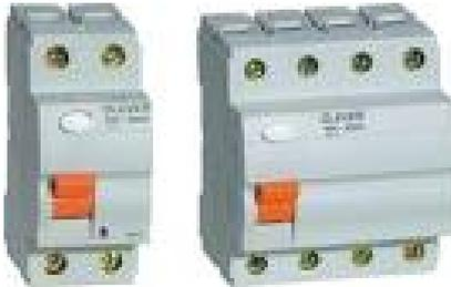
Εγκατάσταση αυτόματων διακοπτών διαρροής ρεύματος (Residual Current Devices, RCDs), ευαισθησίας τουλάχιστον 30mA ή και μικρότερης σε όλα τα κυκλώματα που τροφοδοτούν ρευματοδότες, φορητές ή κινητές συσκευές ή και εξοπλισμό για προστασία από ηλεκτροπληξία. Τα κομβία ελέγχου (test button) των διακοπτών διαρροής ρεύματος (RCDs) πρέπει να ελέγχονται σε τακτά χρονικά διαστήματα έτσι ώστε να εντοπίζεται οποιαδήποτε πιθανή βλάβη του RCD.
